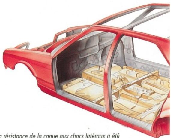
La résistance de la coque aux chocs latéraux a été améliorée grâce aux barres de protection intégrées dans les portes.
