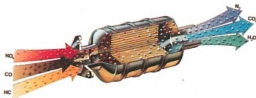
*Le double système d'échappement en acier inoxydable avec deux catalyseurs principaux, deux pré-catalyseurs et deux sondes lambda (une par ligne).*
