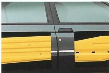
indéformable de l'habitacle. Des barres longitudinales de renfort ont été intégrées dans les portes. Les pare-chocs, d'un dessin spécial, sont en matière plastique haute résistance à base
